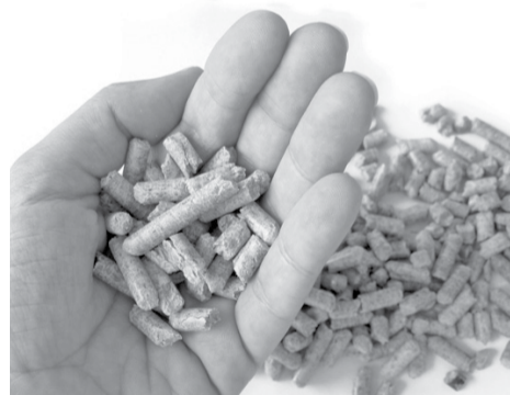
Пеллеты (топливные гранулы) – биотопливо, получаемое из торфа, древесных отходов и отходов сельского хозяйства
